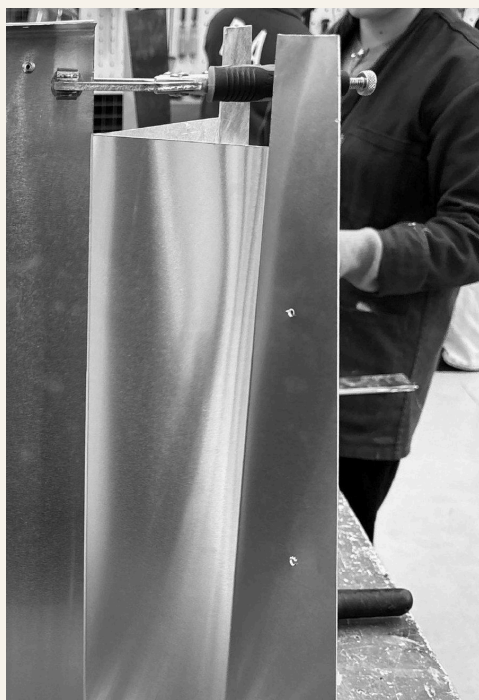
Mise en forme des pieds
